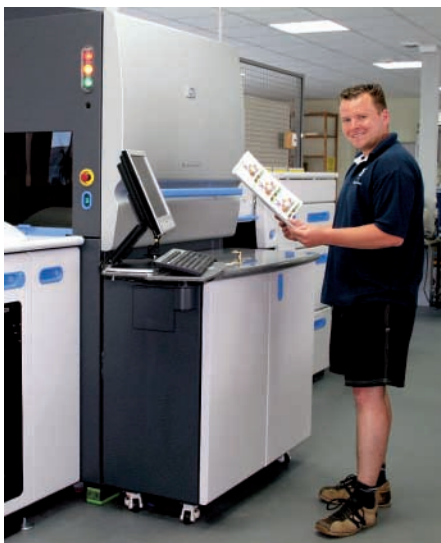
Tobias Menger, Digitaldruck-Operator, an der HP Indigo Press 5000: Die Maschine verarbeitet gestrichene und ungestrichene Papiere.
